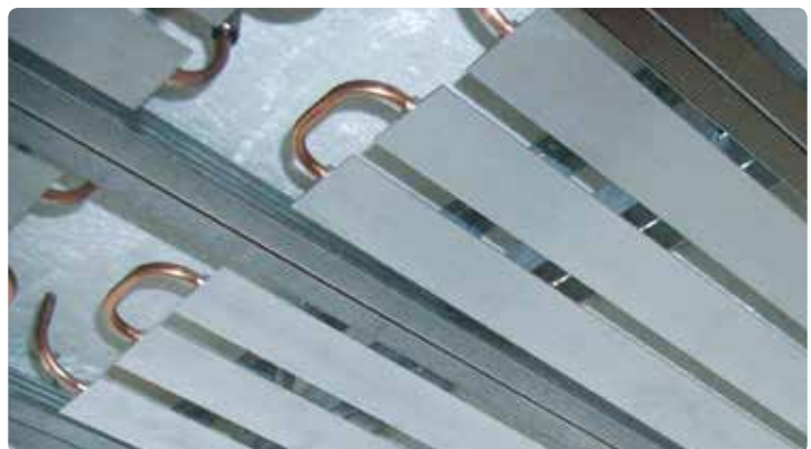
Standard-System mit zusätzlichen CD-Profilen Nennkühlleistung nach EN 14240 bei 8 K Untertemperatur = 58 W/m 2 (RA 90 mm) Theoretisch aktivierbare Deckenfläche = 80 % Kühlleistung bei 8 K Untertemperatur = 46 W/m 2
